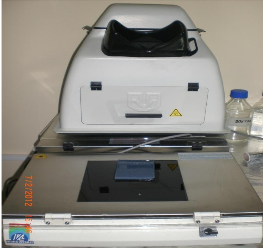
Şekil 4: UV görüntüleme cihazı.
