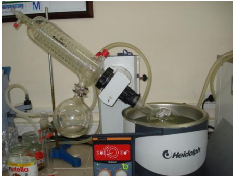
Resim 3: Çözücünün döner buharlaştırıcı ile uzaklaştırılması
