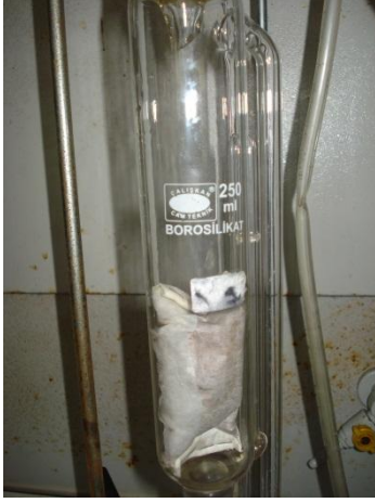
Resim 1: Kara üzüm çekirdeğinin Soxhlet cihazına yerleştirilmesi
